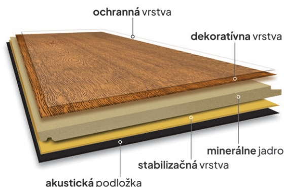
Štruktúra lamely (rez)
